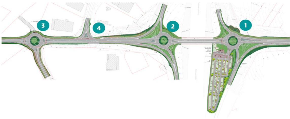
Un cheminement cyclable bidirectionnel de 2,50 mètres, réalisé côté Neufchâteau, permettra aux cyclistes de traverser l'échangeur le long de la N87 en sécurité.
